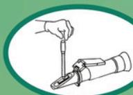
(1) Com o uso da pipeta, pingue 1 a 2 gotas de colostro no prisma.
